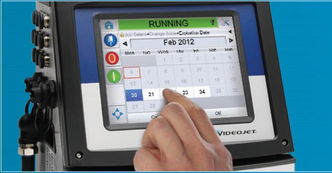
**交互式触摸屏：**我们明亮的264mm (10.4") 触摸屏使您能够在远处轻松监控作业状态。我们快速、直观的界面简化了日常交互，清晰地显示实时液位、维护警报、喷印作业及其他运行信息。
