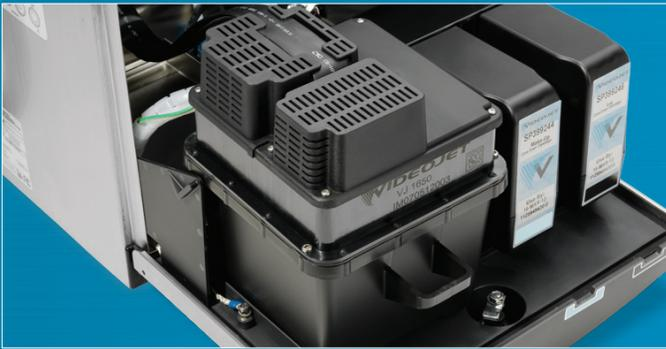
**模块化墨芯：**先进的墨芯设计使1550和1650喷码机能够在计划内维护期间连续运行长达14,000小时。墨芯可由客户更换，包括所有墨水系统过滤器和常见的磨损部件。
