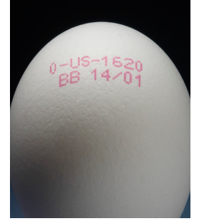
Yumurta kabuğu üzerine mürekkep püskürtmeli kodlama
