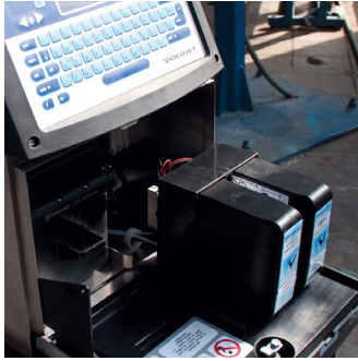
Videojet 1710 kodlayıcısındaki Smart Cartridge™ (Akıllı Kartuş) sıvı aktarım sistemi
