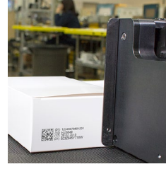
Kaplamalı bir karton üzerinde 2D DataMatrix kod
