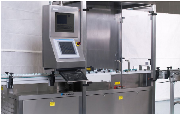
FP Developments Verpackungslösung mit Videojet UV-Laserinstallation
