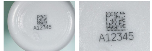
Kontraststarke UV-Lasermarkierung auf HDPE-Flasche
