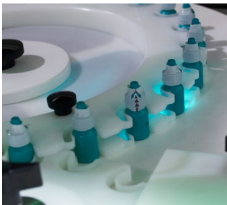
"Star Wheel"-Transport für Positivkontrolle der Flaschen während des Markierungsvorgangs
