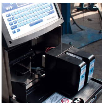
Das Smart Cartridge™-Fluid Delivery System im neuem Videojet 1710-Drucker von Baosheng
