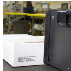
2D DataMatrix-Code auf beschichtetem Karton
