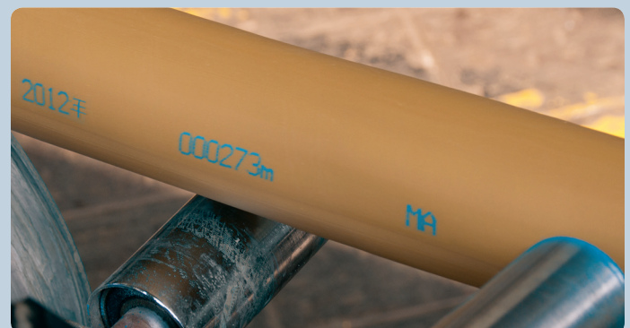
Codificación por chorro de tinta de alto contraste en cable de calibre grande
