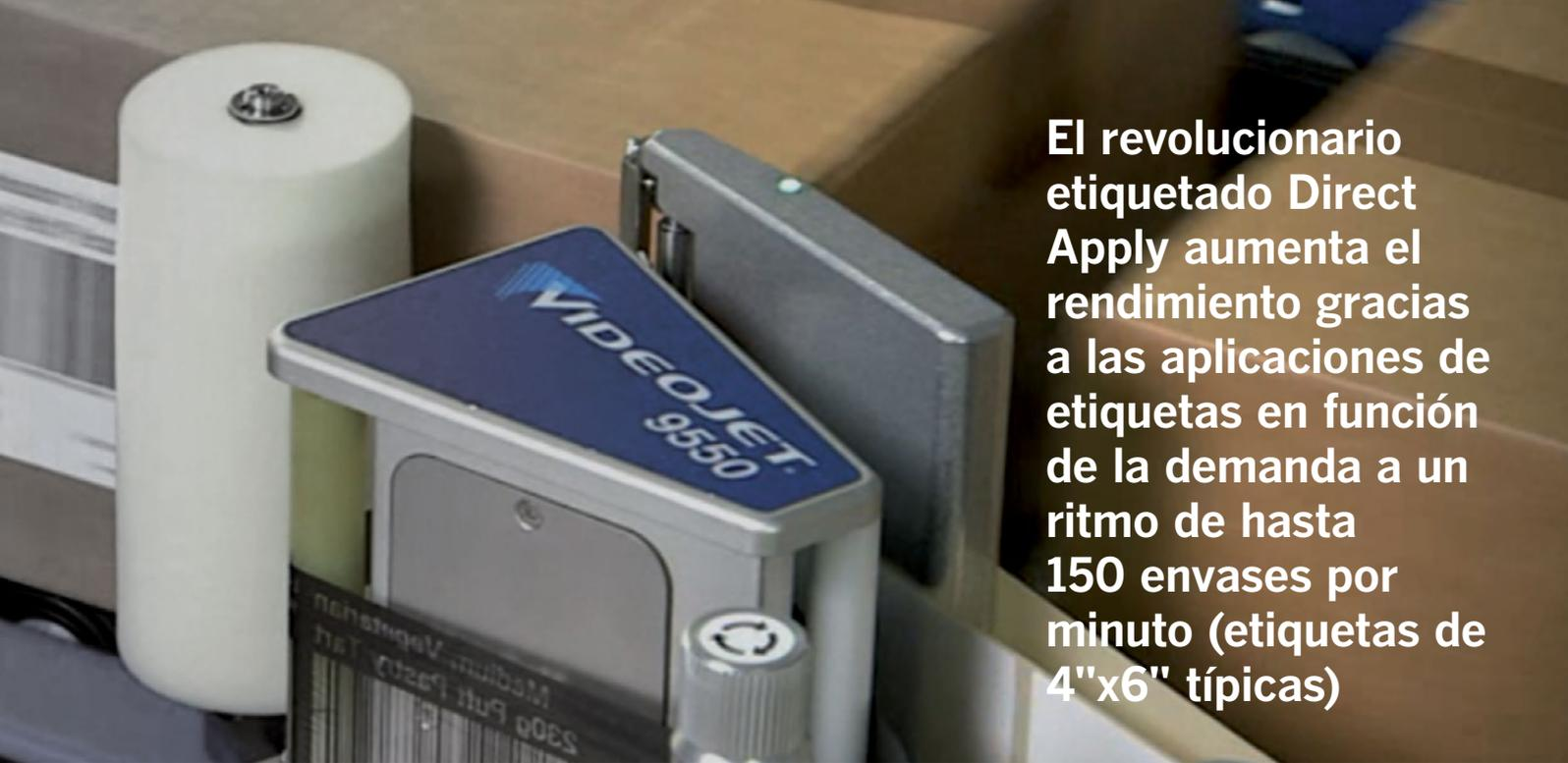
El revolucionario etiquetado Direct Apply aumenta el rendimiento gracias a las aplicaciones de etiquetas en función de la demanda a un ritmo de hasta 150 envases por minuto (etiquetas de 4"x6" típicas)
