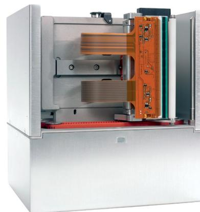
Los componentes de desgaste limitado son rápidos y fáciles de cambiar, lo que ayuda a asegurar que los fabricantes se ponen en marcha lo más rápido posible. El nuevo diseño de cabezal de impresión es fácil de reemplazar y no requiere intervención adicional del operario para volver a la impresión.
