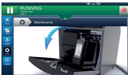
Nuestro sistema Smart Cartridge™ de Videojet, que evita la suciedad, los desechos y los errores, drena todos los fluidos del cartucho y ofrece protección adicional contra las fugas durante el transporte y la manipulación. El diseño de Videojet SmartCell™ también ayuda a simplificar el mantenimiento rutinario.
