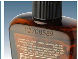
Código láser directamente en botella con pulverizador
