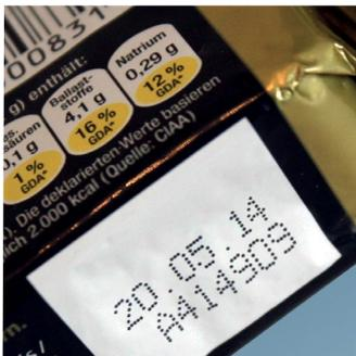
Следует выбрать мелкосимвольный каплеструйный принтер с небольшим и предсказуемым объемом обслуживания и способный долго работать без участия оператора.
