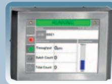
Простой в использовании сенсорный дисплей с диагональю 8,4 дюйма с функцией WSYSWYG, позволяет сократить количество ошибок при загрузке и выводе данных.
