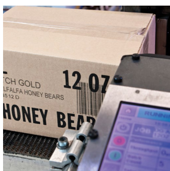
Videojet 2350 наносит маркировку на упаковочные ящики
