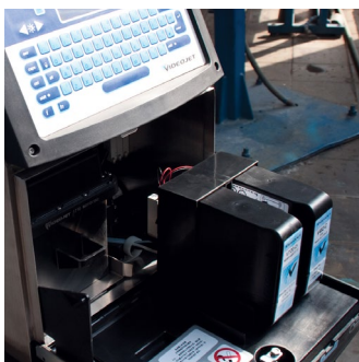
Система подачи чернил Smart Cartridge™ в маркираторе Videojet 1710
