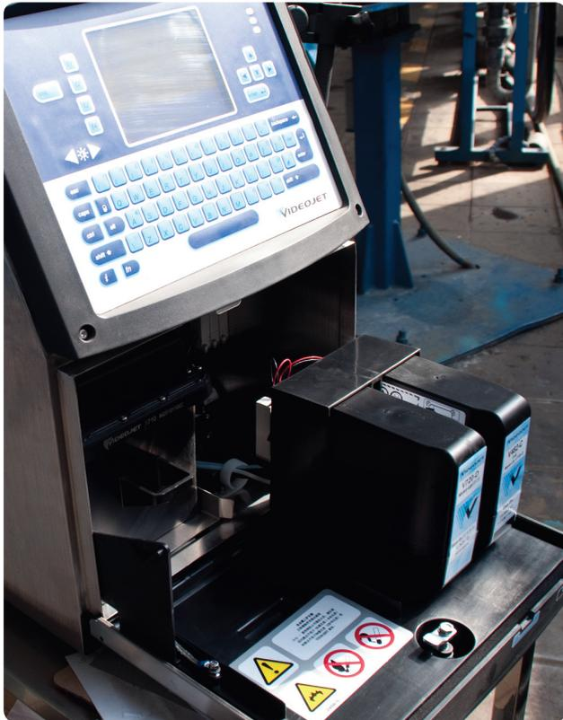
Система подачи чернил Smart Cartridge™ в новом маркираторе Videojet 1710, установленном на заводе Baosheng.
