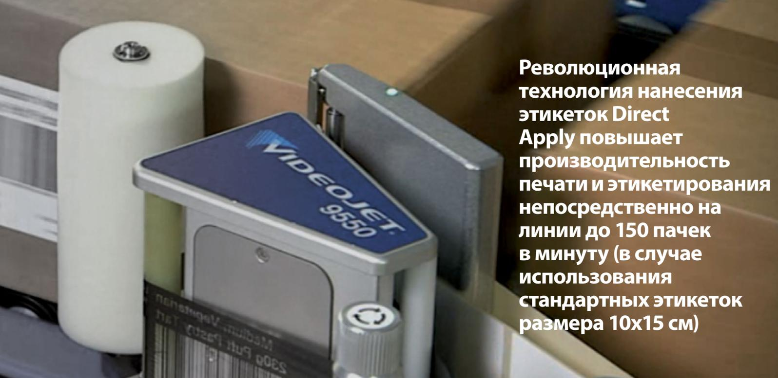
Революционная технология нанесения этикеток **Direct Apply** повышает производительность печати и этикетирования непосредственно на линии до 150 пачек в минуту (в случае использования стандартных этикеток размера 10x15 см)
