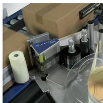
Принтер-аппликатор Videojet 9550 исключает необходимость в разделении конвейерной линии, так как может работать на высоких скоростях
