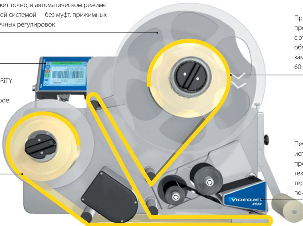
Простой алгоритм протяжки рулона с этикетками и риббона обеспечивает их замену менее чем за 60 секунд
