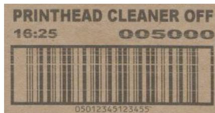
Хорошо видны засоры и снижение качества маркировки
