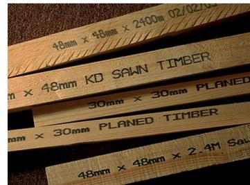
**Нанесение маркировки непосредственно на строительные материалы**
