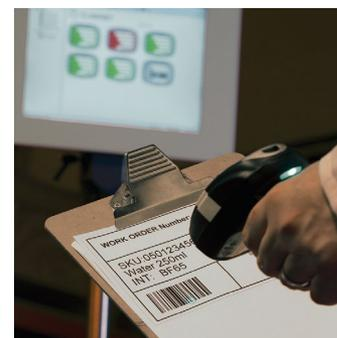
**Ручной сканер можно использовать для вызова задания на печать из рабочего заказа, а с помощью ПО CLARiSUITE® он может автоматически заполнять необходимые данные маркировки.**
