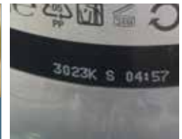
Белая маркировка, нанесенная на флакон с дезодорантом с помощью каплеу струйной печати
