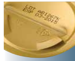
Черная маркировка, нанесенная на цветную бутылку с помощью каплеу струйной печати
