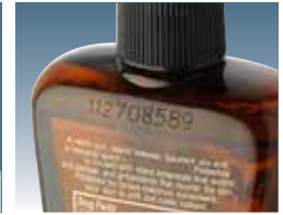
Лазерная маркировка непосредственно на аэрозольном баллончике
