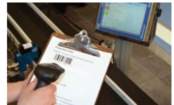
Задания на печать можно отправлять на принтер с помощью ручного сканера
