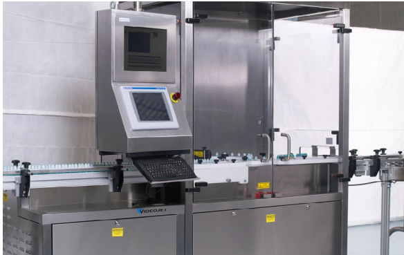
Решение для упаковки от компании FP Developments с установленной системой маркировки ультрафиолетовым лазером Videojet
