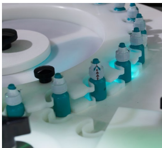
Перемещение флаконов на линии с помощью храпового механизма для лучшего контроля их положения во время нанесения маркировки.
