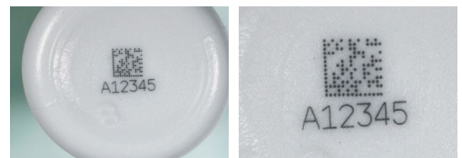
Высококонтрастная маркировка ультрафиолетовым лазером на флаконе из ПНД
