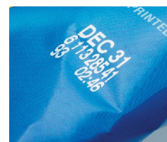
Высококачественная маркировка, полученная методом термотрансферной печати
