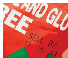
Некачественная маркировка, полученная методом горячего тиснения
