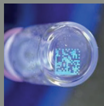
Маркировка УФ-чернилами V459-D на дне стеклянного флакона
