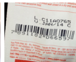
Штрихкод, нанесенный на блистер каплетруйным принтером
