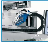
Os cabeças de impressão azuis da Wolke montados na base de uma termoformadora. Os cabeças de impressão movem-se da direita para a esquerda, codificando várias embalagens em uma única passagem.
