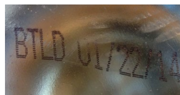
Niska przyczepność atramentu — rozmazane oznakowanie
