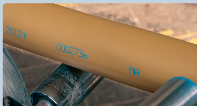
Znakowanie atramentowe o wysokim kontraście na kablach o małej średnicy
