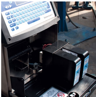
Smart Cartridge™ vloeistofsysteem in het Videojet 1710-codeersysteem
