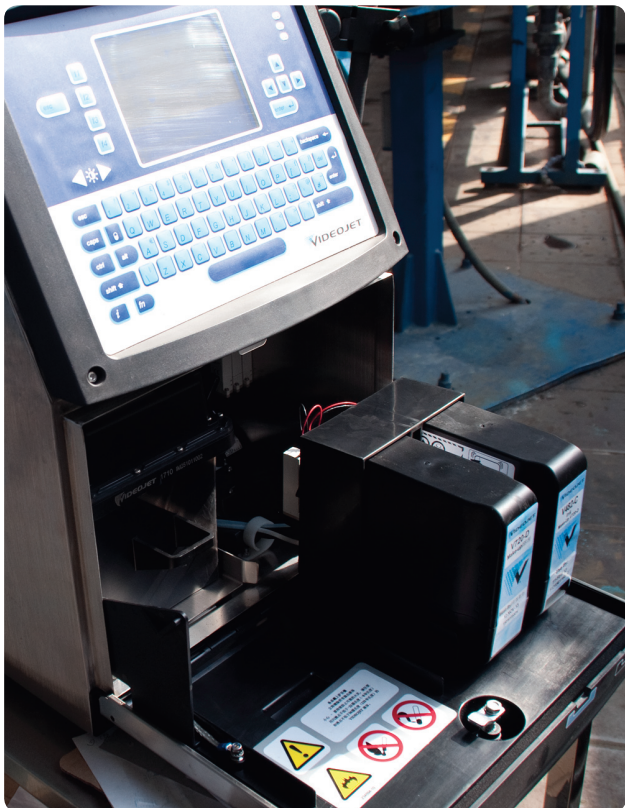
Het Smart Cartridge™ vloeistof toevoersysteem in de nieuwe Videojet 1710 van Baosheng
