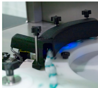
Flessen worden op de bodem gemarkeerd; laserschild wordt zwart weergegeven
