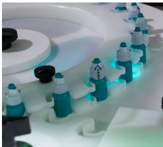
Sterwieltransport voor positieve flescontrole tijdens markeren
