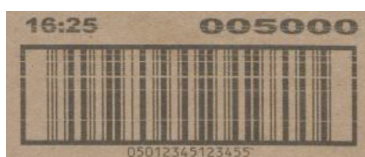
ヘッドクリーナがオフ状態での印字
