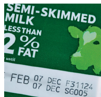
期限情報のマーキング 乳製品の厚紙製箱の フィルムに施された レーザー感応コー ティングの色変化
