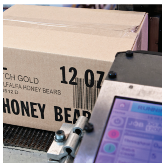
Videojet 2350 による出荷用段ボール箱への印字
