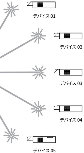
複数のレーザーマーカを、Web ブラウザ上で実行する TCS+ から制御できます。各レーザーマーカは、Web ブラウザ内の個別のタブで表されます。すべてのレーザーマーカは、Web ブラウザで TCS+ を実行している PC またはブラウザ対応のデバイスと同じネットワーク内になければなりません。WiFi 経由でレーザーマーカを制御するには、各レーザーマーカに WiFi キットを装備し、お客様のネットワークにログインする必要があります。
