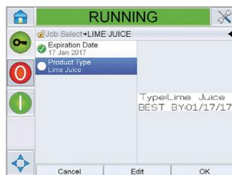
事前定義されたジョブの設定規則に基づき、許可されているフィールドのみ編集できます。それぞれの入力内容をオペレーターが確認して初めて、印字ジョブの読み込みが可能になります。
