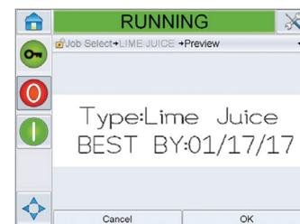
印字レイアウトをプレビューすることにより、正しいジョブが読み込まれたこと、入力したデータが正しいことを印字前に確認できます。
