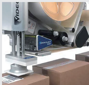
タンプ方式 (押し貼り)
