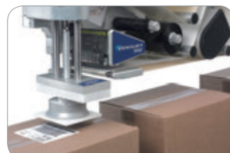
押し貼り 箱 (高さ変動可) の天面から貼付
