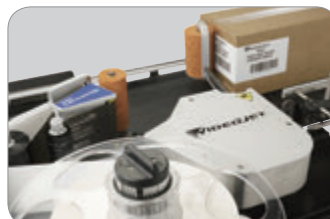
角貼り エア駆動のローバーで角貼付
