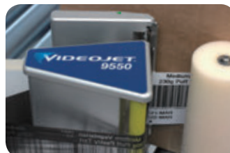
直貼り/なめ貼り 箱 (固定高さ) の天面と側面に貼付
