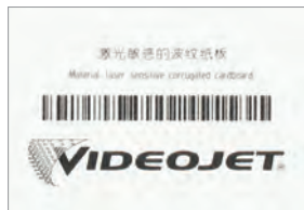
レーザー反応性ダンボール (色変化)
