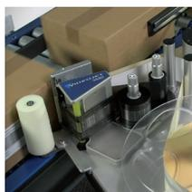
Videojet 9550 は、高速でラベルを印字・貼付けできるので、従来のように生産ラインの速度に合わせて、生産ラインを分岐させて 2 台のラベラーを設置する必要がなくなります。
