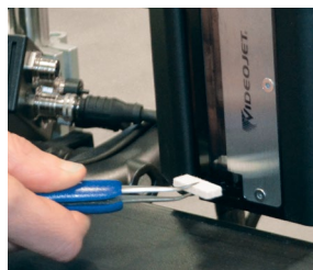
素早く、容易かつ汚れずに回収ラインフィルタの交換が可能
