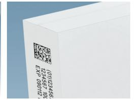
熱転写サーマルインクジェット:紙製バック印字された二次元バーコード
