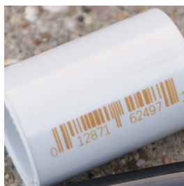
レーザーマーカの印字 (発色印字)
