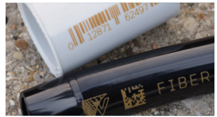
パイプへのレーザーマーキング例
