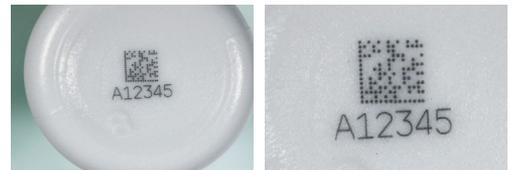
HDPE (高密度ポリエチレン) 容器への高コントラストの UV レーザーマーカ印字
