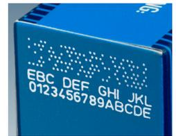
ドット印字とCodentify印字のマーキング例
