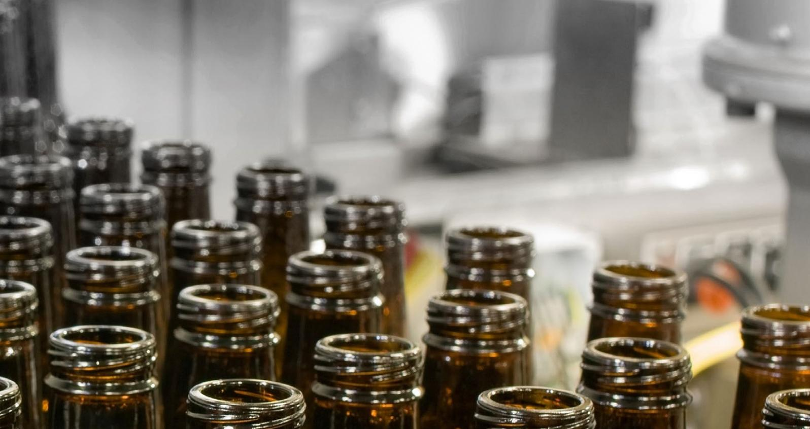
**2. Stampare il codice al di sopra della linea di riempimento.** Sulla maggior parte delle bottiglie in plastica e vetro, la prassi migliore consiste nell'applicare il codice al di sopra della linea di riempimento della bevanda, vale a dire nel punto in cui si forma meno condensa rispetto all'area dove si trova il liquido. Infatti, il livello di condensa in questo punto sarà inferiore che non sulla superficie a diretto contatto con la bevanda.
