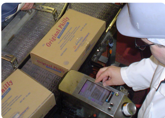
Lo schermo touchscreen precaricato del modello Videojet 2300 permette di effettuare semplici sostituzioni di prodotti
