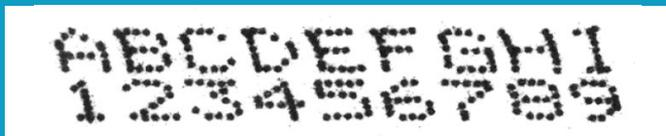
Codifica ad alta velocità di Videojet grazie al posizionamento ottimizzato delle gocce
