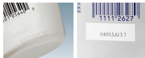
Codice illeggibile e posizionato scorrettamente
